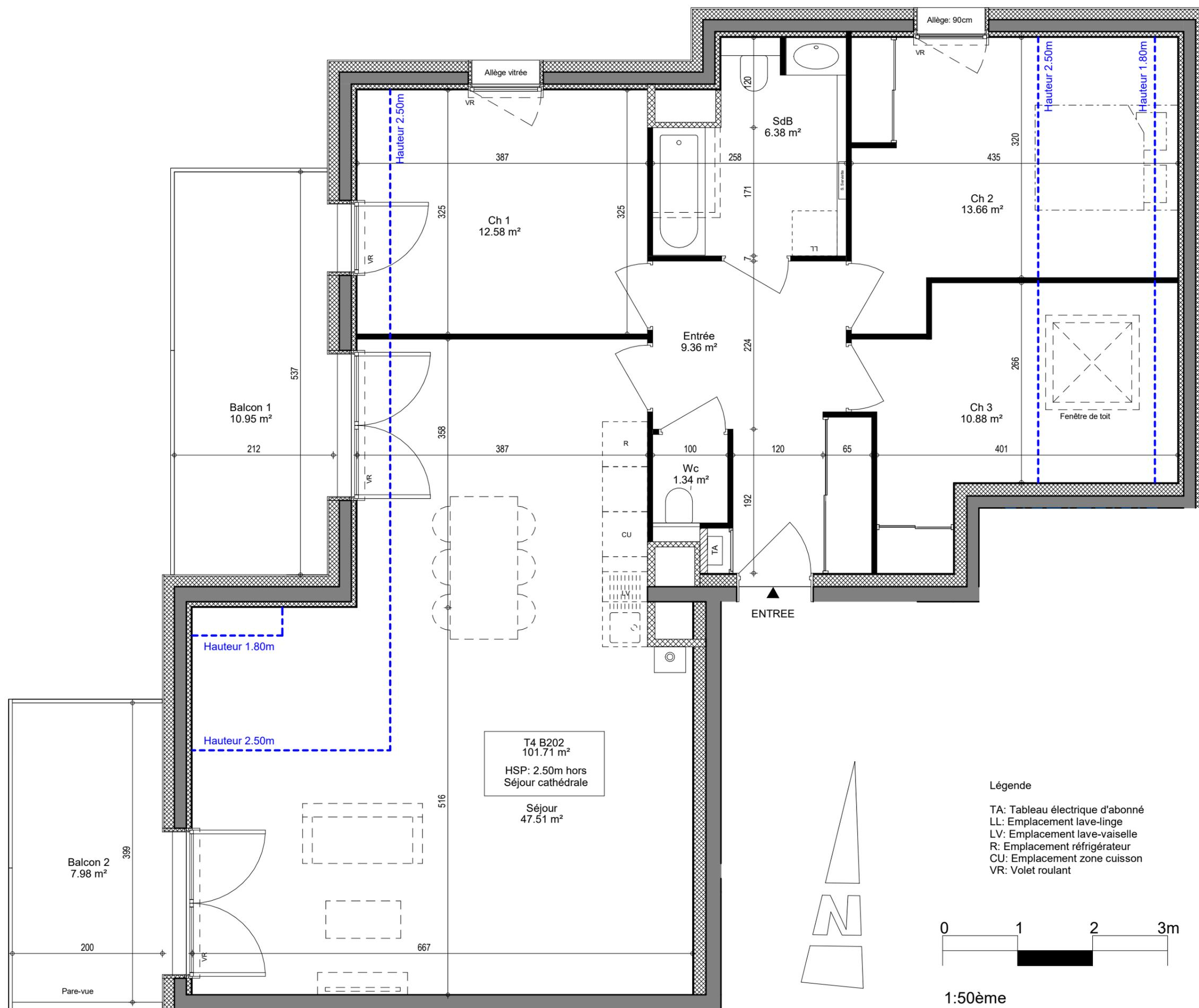
NOTA: Des modifications sont susceptibles d'être apportées à ce plan en fonction des nécessités techniques de la réalisation, tant en ce qui concerne les dimensions, que les équipements sanitaires et électriques (mobilier et électroménagers non fournis). Les surfaces indiquées sont approximatives. Les retombées, soffites et faux-plafonds, ainsi que l'emplacement des équipements ne sont pas tous figurés ou le sont à titre indicatif.
